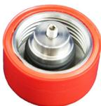
Der PB+CO®lock Blindstopfen sichert die Messpunktschnittstelle während der Sensor deinstalliert ist. Der PB+CO®lock dichtet metallisch und zusätzlich über einen O-Ring redundant ab.
