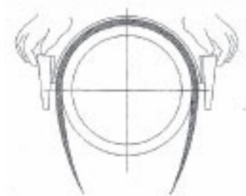
An einer Seite den Haltebügel korrekt über das Schraubenjoch hängen.
