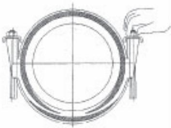
Mit dem Schraubenschlüssel weiterdrehen bis der Haltebügel über das Schraubenjoch rutscht und einrastet.
