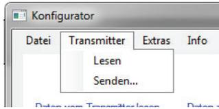
**Lesen** mit diesem Befehl wird die aktuelle Konfiguration vom Transmitter gelesen.
