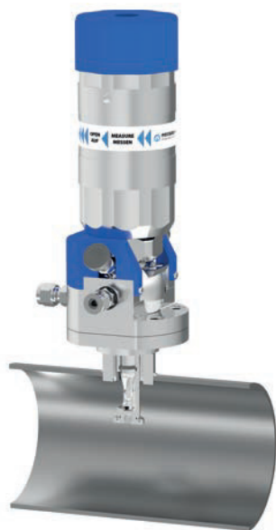
Abb. 2: WA 3.2 Messen: Schwenkarmatur und Wechselarmatur in Messposition – die Wechselarmatur mit einem langen Hub gibt den Sensor zur Messung frei.
