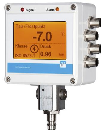
Unsere Drucksensoren messen Relativdruck und wandeln diese Messgröße (bar<sub>ü</sub>) in ein Normsignal von 0 bis 10 V oder 4 bis 20 mA um.
