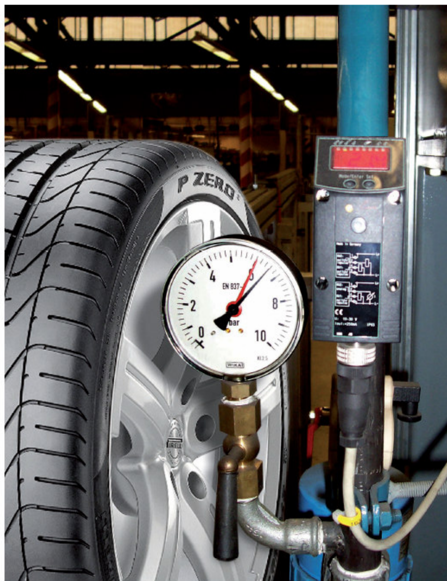
Messarmatur mit Druckluftzähler in der Pirelli Reifenproduktion
