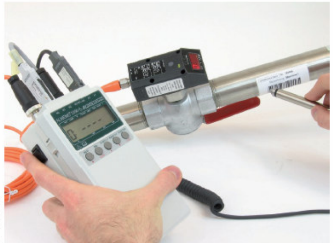
Druckluftmessgerät mobile 104i mit Datenlogger, Akkupack und Barcode-Leser
