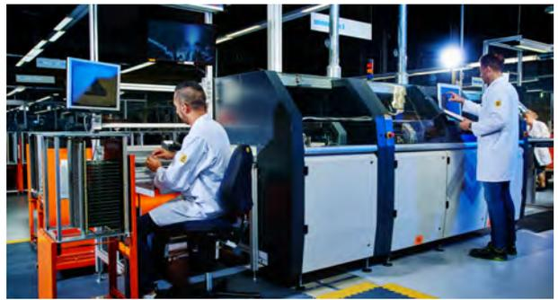
Die Maschinen verfügen über Sensoren, die zum Beispiel Bauteilqualität oder Energieverbrauch ermitteln. Alle Daten werden erfasst, dokumentiert und ausgewertet.
