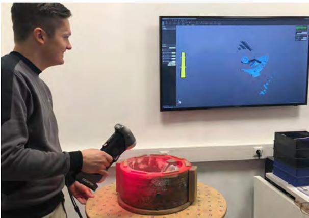
Auch alte Pumpenbauteile werden gescannt. Anschließend prüfen Experten ihr Design und optimieren den Wirkungsgrad der Komponenten.
